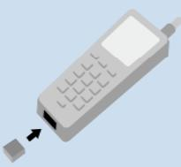
注型樹脂の注入口となるゲートを、原型に取り付けます。
